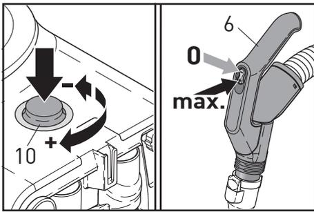
Schalten Sie nun das Gerät durch Drücken des Schaltknopfes (10) ein. Die gewünschte Saugkraft können Sie durch Drehen des Schaltknopfes (10) am Gerät (nicht D4) regulieren.
