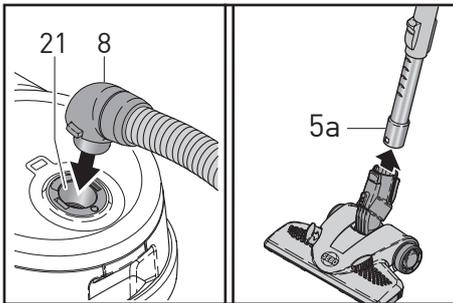
Stecken Sie den Schlauchstutzen (8) in den Sauganschluss (21) bis er einrastet. Schieben Sie eine SEBO Bodendüse oder Elektroteppichbürste\* bis zur Rastung auf das untere Ende des (Elektro-) Teleskoprohres (5a). Stecken Sie nun den Handgriff (6) in die andere Seite des Teleskoprohres (5) ein. Fertig!
